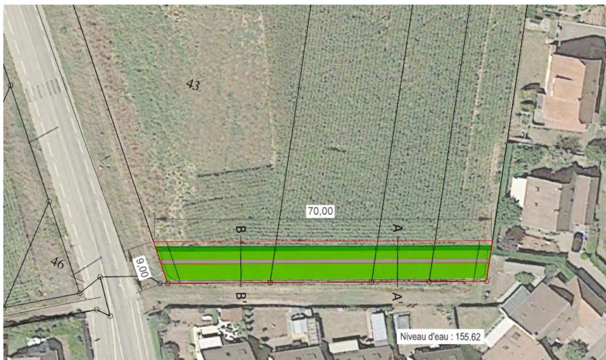
Figure 4 – Emprise de l'aménagement d'infiltration
